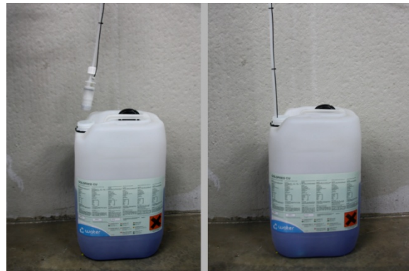
Abbildung 6: Saugschlauch in die Flüssigkeit hängen
