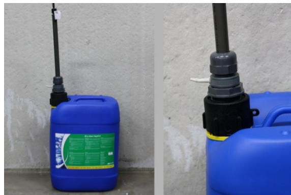
Abbildung 6: Sauglanze mit dem Behälter verbinden
